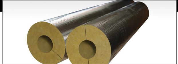
Maßgenau geschnittene Steinwoll - Rohrschalen, einseitig geschlitzt, kaschiert mit einer reißfesten Reinaluminiumfolie, in AS - Qualität nach AGI Q135, stark wasserabweisend und geruchsneutral. Einfache Montage durch doppelseitiges Klebeband mit Fingerlift zum Verschließen der Rohrschale.
